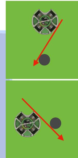
アタッカーのプログラムでは、ボールの距離・角度の情報をもとに、逆三角関数を使ってボールとロボットの共通接線の方向を求めることによって、最短距離での回り込みを実現しています。
